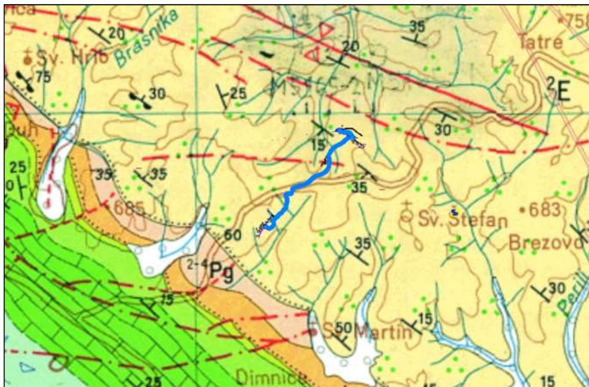
Slika 4: Izsek iz Osnovne geološke karte list Ilirska Bistrica (Šikić, Pleničar, Šparica, 1972) z označeno obravnavano traso. Legenda: 2 E - flišni sedimenti: glina, pesek, prod, konglomerat
